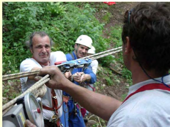
Essai dynamométrique des cordes
