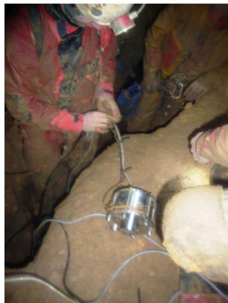
*Pose d'un fluorimètre dans le gouffre des Essarlottes à Gévresin G.S.D*
