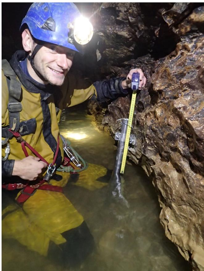
relevés. Puis nous essayons de mesurer des vitesses (Nous n'y avons pas pensé et nous utilisons comme flotteur un paquet de mouchoir étanchéifié, nous ferons mieux la prochaine fois, peut-être même une mesure chimique). La section est évaluée à 0,46 m<sup>2</sup> et la moyenne des vitesses à 0.041 m/s, ce qui donne 19 l/s pour 56 l/s à la station DREAL de la résurgence. Avec 1/3 du débit, il n'y a rien d'aberrant.
