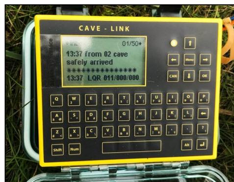
touches permet l'écriture de messages de 200 caractères maximum. Les différentes fonctions du Cave-Link sont accessibles par un ensemble de menus configurables par l'utilisateur. Le menu de base (Normal Mode) ne permet que la transmission ou la réception de messages SMS. Un mode Expert (Expert Mode) permet l'accès à d'autres fonctions du Cave-Link.
